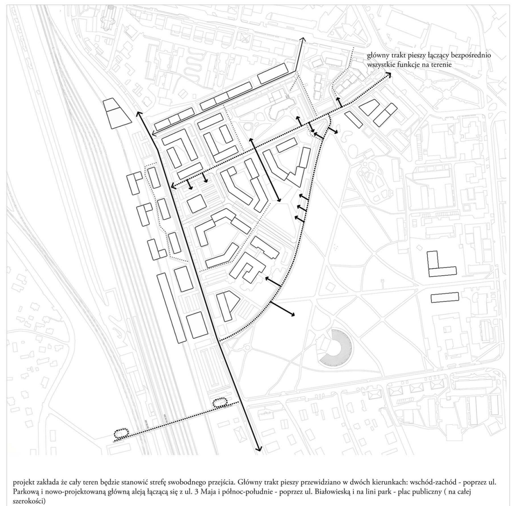
projekt zakłada przebudowę układu drogowego na terenie, kładąc nacisk na ograniczenie ruchu na ul. Parkowej, poprzez przeniesienie go na nowo-projektowaną drogę podziemną. Plan zakłada powstanie strefy o uspokojonym ruchu, z drogami współdzielonymi - bez wyznaczania odrębnych ścieżek rowerowych czy przejazd dla pieszych. W celu zwiększenia bezpieczeństwa w ważnych miejscach np. skrzyżowaniach czy przerwanach przez drogi traktach - proponuje się ich wyzniesienie na poziom chodnika komunikacja kołowa
